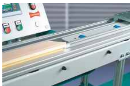
Bande d'acheminement avec guide et butées
