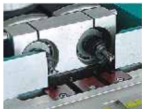
Agrégat de fraisage avec écart de 65 mm.
